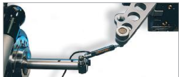
Набор переходников для диагностики токарных станков по полной окружности
