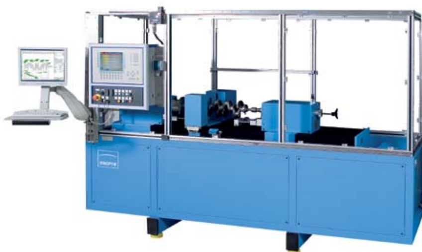
opticlone AMV923H, с коленчатым валом, для последовательного измерения при заключительной обработке
