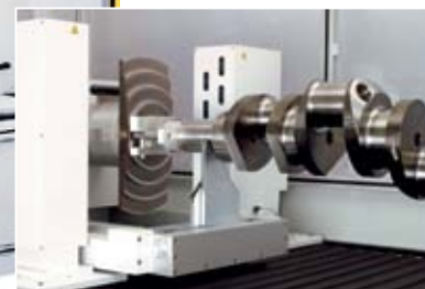
opticlone WMS2548, размеры объектов до: D = 480 мм, L = 2500 мм, возможность применения: валы авиационных двигателей
