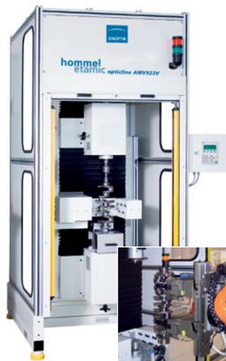
opticlone AMV923V, коленчатый вал, загрузка роботом
