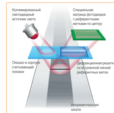
Оптическая схема системы TONiC
