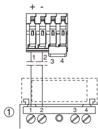
Схема подключения (однокамерный корпус)
