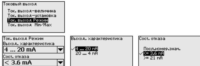
Заводская установка: выходная характеристика 4 ... 20 mA, состояние отказа < 3,6 mA.
