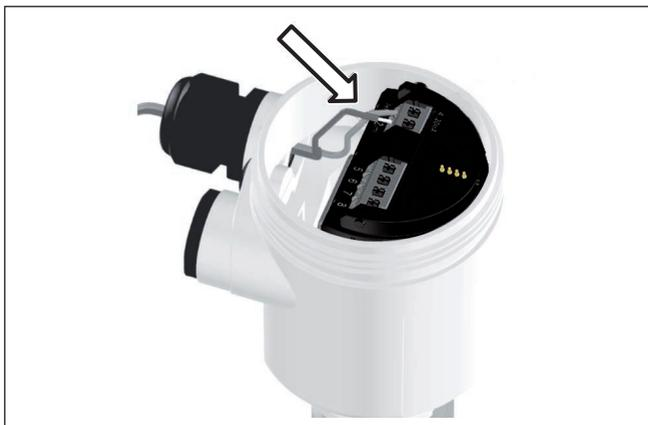
Рис. 14: Шаги подключения 5 и 6 - однокамерный корпус
