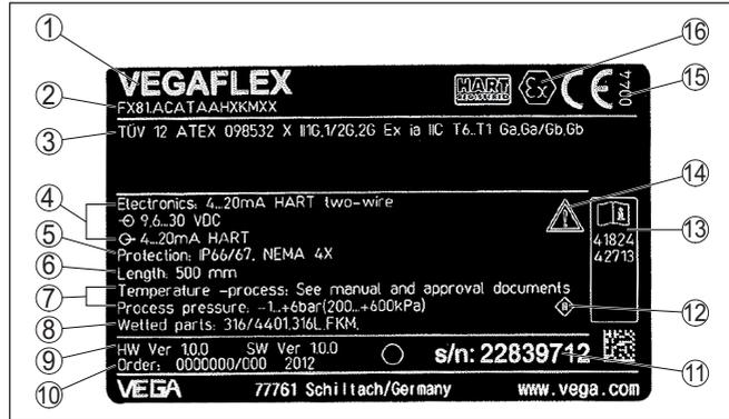
Рис. 4: Данные на типовом шильдике (пример)
