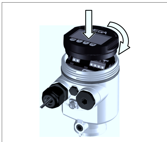
Рис. 29: Установка модуля индикации и настройки в отсеке электроники однокамерного корпуса
