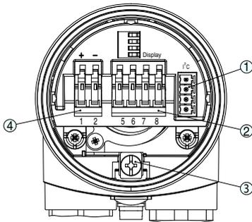
Отсек электроники и подключения - однокамерный корпус
